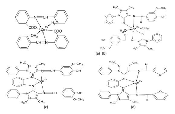
Figure-4 Structure of (a) ZnVA (b) ZnAV (c) ZnAVOP and (d) ZnAFOP complexes
